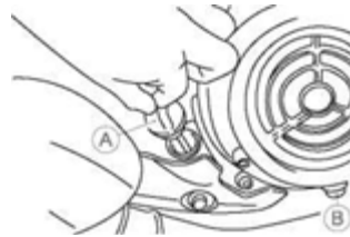
(A) Einfüllstutzen. (B) Ölablassschraube (Motorunterseite)
